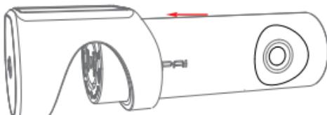
3. Зніміть захисну плівку з задньої частини кронштейна, прикріпіть кронштейн клейкою стороною до лобового скла, розташувавши його так щоб камера мала безперешкодний вид на дорогу та не заважала огляду водія.
